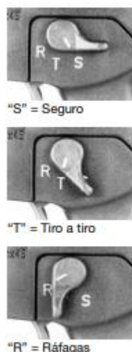
Ilustración 3 Posiciones de la aleta selectora Sistema de accionamiento por gas.
