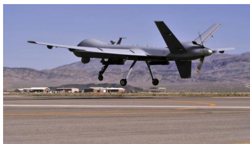
Figura 7 Un dron MQ-9 Reaper de la Fuerza Aérea de EEUU, Fuente: vozdeamerica.com
