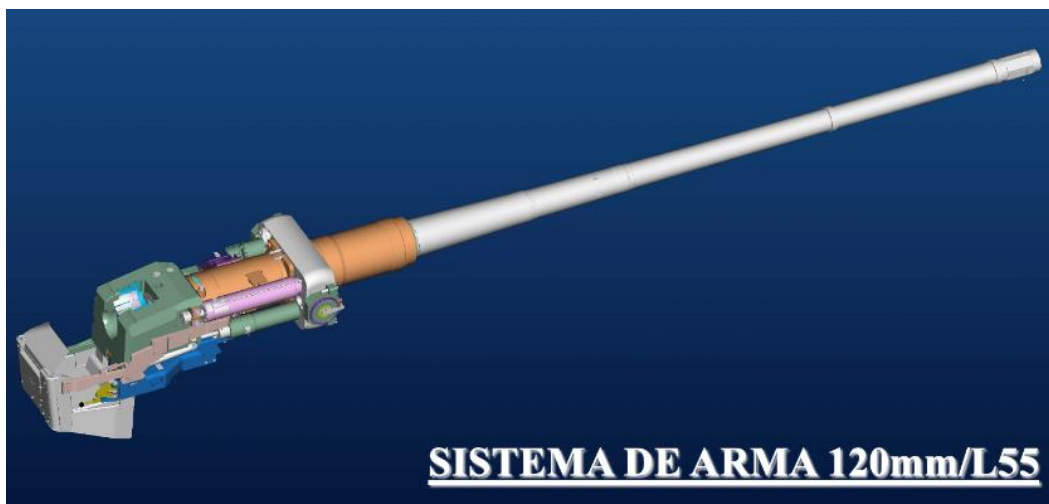
Fig 4-1. Sistema de cañón 120 mm/L55 de Leopard 2E.
