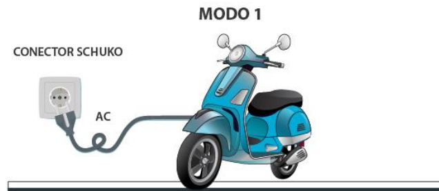
Figura 42 Modo 1 de recarga de vehículos eléctricos [40].
