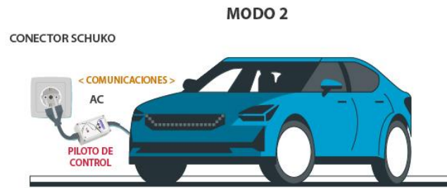
Figura 43 Modo 2 de recarga de vehículos eléctricos [40].
