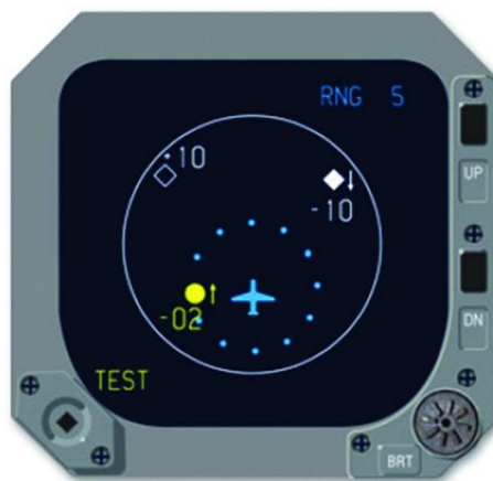
Figura 9. Avisos de tráfico del TCAS. Fuente: Transponder1200
