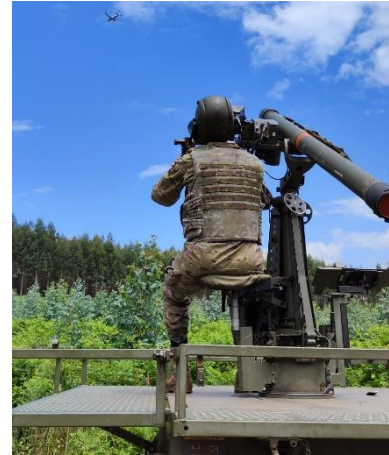
Figura 10 Seguimiento de una aeronave con Mistral. Fuente: Elaboración Propia
