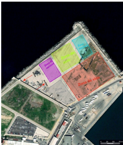
Ilustración 13. Esquema del diseño del campamento en el emplazamiento. Fuente propia.
