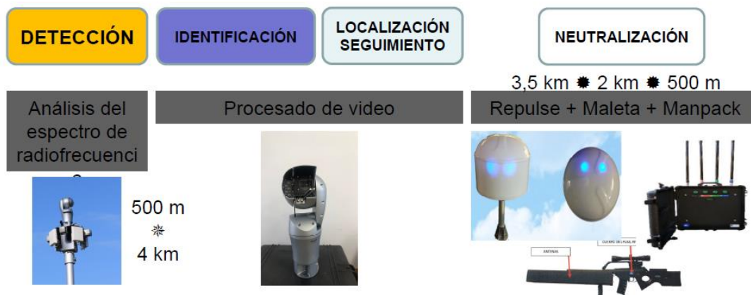
Figura 17. Subsistemas del sistema CERVUS. Fuente: [22]
