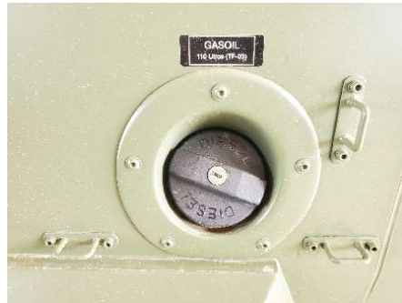
Figura 12 Capacidad reflejada en tapa de combustible del VAMTAC. Fuente: Elaboración propia
