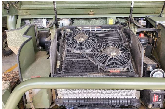
Figura 13 Radiador, motor y niveles del VAMTAC. Fuente: Elaboración propia
