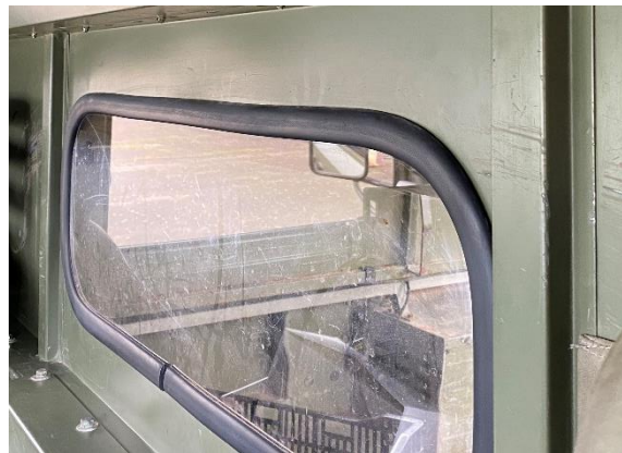
Figura 21. Ventana que deberá quitarse para pasar el cableado. Fuente: [Elaboración propia]
