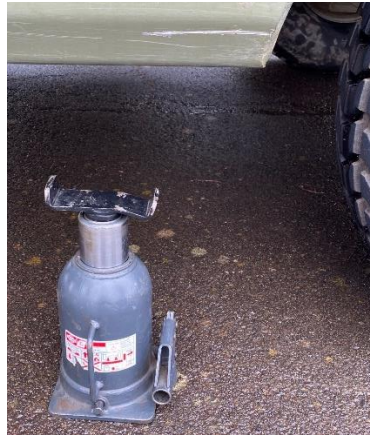
Figura 10. Gato completamente abierto y no llega al chasis del vehículo. Fuente: [Elaboración propia]
