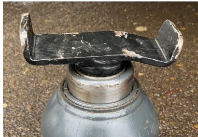
Figura 11. Plataforma del gato deformada después de su uso. Fuente: [Elaboración propia]
