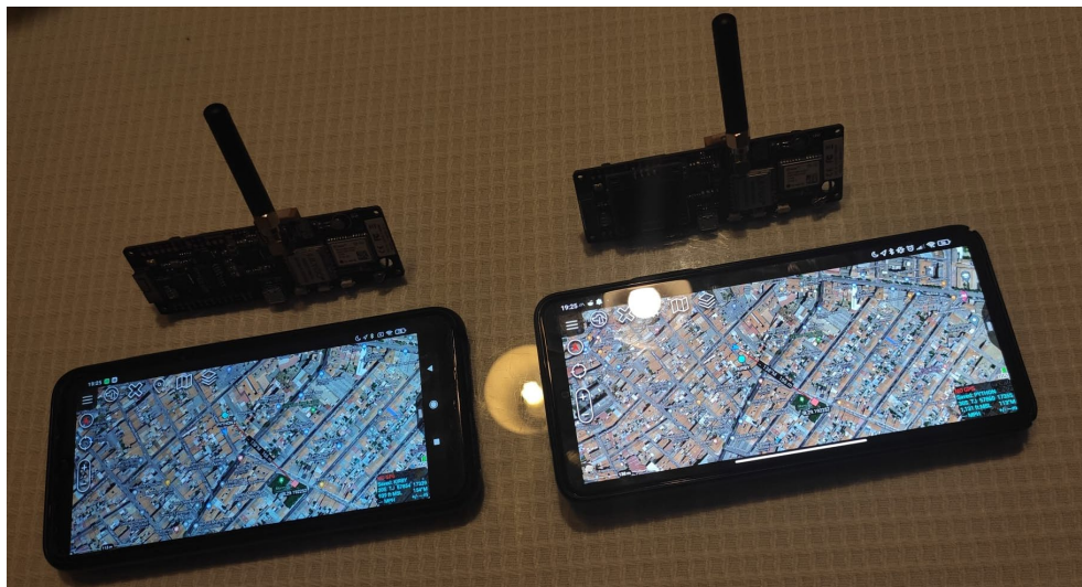
Figura 19: Prueba de enlace con dispositivos LoRa. Fuente: Sdo. Alejandro.
