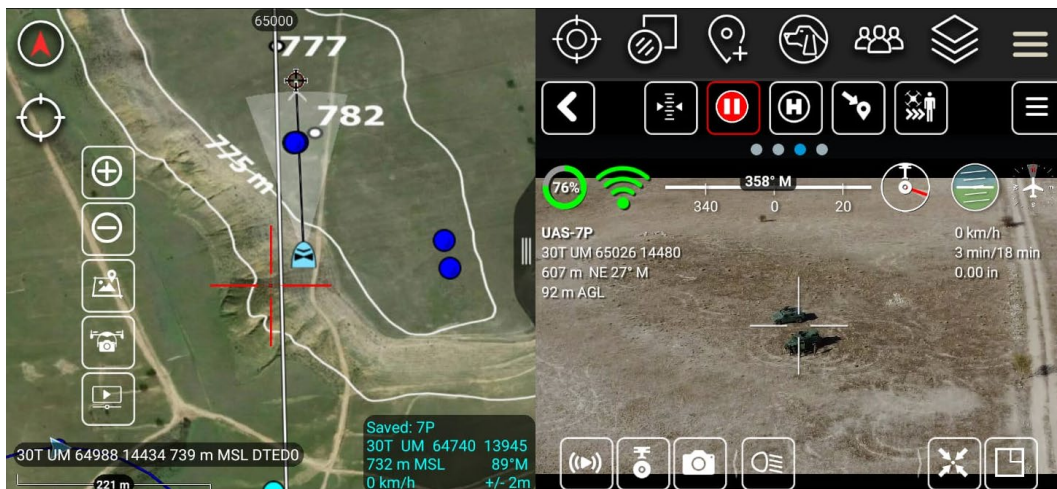
Figura 12: Designación de objetivos mediante dron. Elaboración propia.
