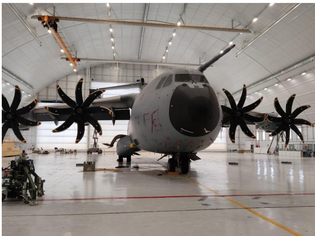
Figs. 31 y 32. Hangares. Exterior del Airbus A400M. Los motores Europrop, fabricados por Rolls-Royce en Reino Unido, son desmontados para una inspección periódica. Nótese que la tapa de las hélices está removida. El mantenimiento de 2º Escalón se realiza en los propios hangares del Ala 31. A la aeronave de la fotografía se le está realizando un cambio de aceite en sus cuatro turbopropulsores. En el interior de los hangares hay tomas de energía eléctrica a la que se conecta el Airbus para que el sistema eléctrico pueda registrar las operaciones efectuadas a la aeronave por el personal de mantenimiento. Fuente: Elaboración propia.
