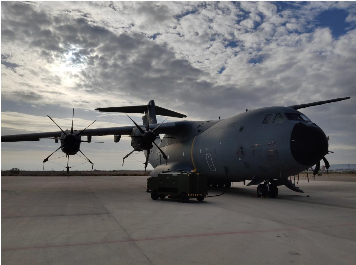
Fig. 33. Airbus A400M en el exterior de los hangares, pista de despegue del Ala 31. Los vehículos utilizados para proceder al mantenimiento de la aeronave en tierra son idénticos al modelo civil que utiliza Airbus. Obsérvense las cubiertas de las palas de las hélices que se utilizan para proteger al avión de las inclinencias meteorológicas en tierra, así como la lluvia, el sol, las ráfagas de viento, el polvo, o la arena, así como las mismas cubiertas que se añaden a los sensores exteriores (parte anterior del avión, bajo la cabina de mando) con el mismo fin. Cualquier leve interferencia con la medición podría poner en jaque el vuelo, por eso cuando el avión se encuentra en tierra firma se procede a tapar cuidadosamente todo elemento sensible. Es de vital importancia proceder a retirarlos antes de volar, por este motivo, están pintados en un fuerte color rojo y reza en ellos la famosa expresión de "Remove Before Flight". Explicación: Sgt 1º. D. Óscar López, responsable de carga del Airbus A400M. Fuente: Elaboración propia.
