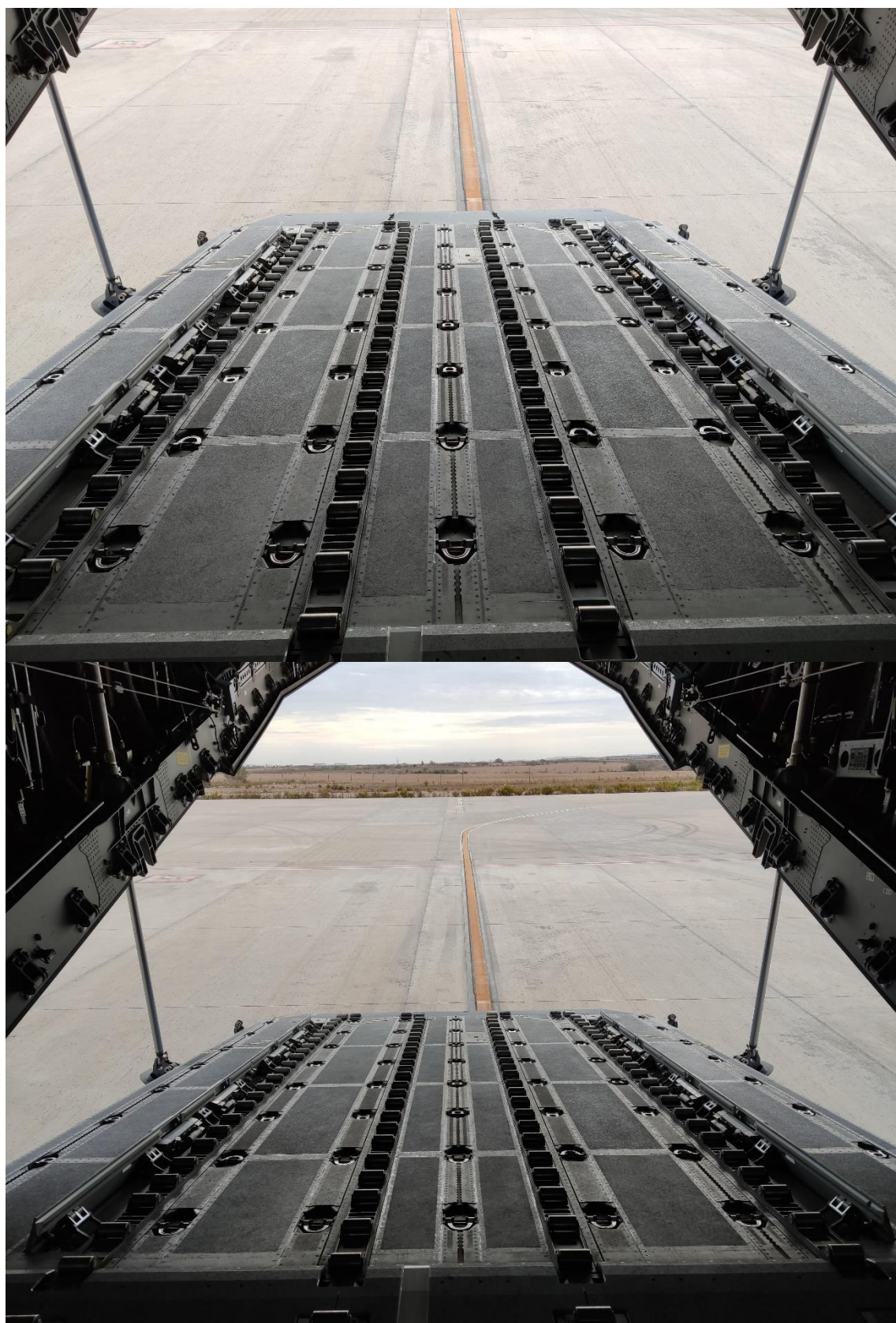
Figs. 43 y 44. Compuerta trasera de la cabina de carga. Vista desde el interior. Fuente: Elaboración propia.
