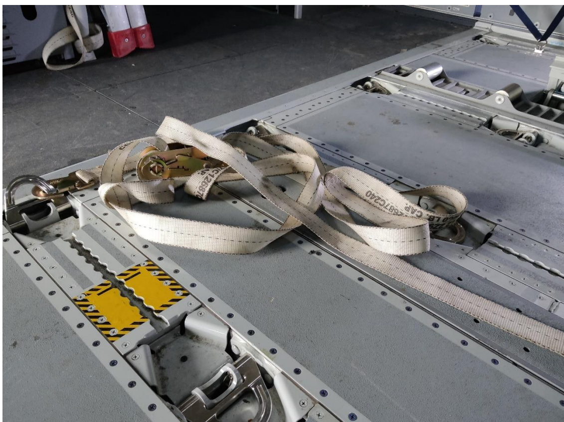
Fig. 49. Suelo interior de dicha cabina de carga. Se aprecian en los laterales de la misma los thruways o zonas destinadas a soportar la carga de las rodadas de los vehículos, y en la parte central de la imagen unas eslingas o cadenas de amarre, junto con los bearings o anillos de sujeción destinados a soportar las mismas. Las eslingas pasan periódicamente procesos de mantenimiento por personal técnico cualificado con el objeto de verificar y garantizar su funcionamiento óptimo, y que aguanten el peso indicado (restraint). (3G hacia adelante, 2G en vertical, y 1,5G hacia los laterales y hacia adetrás). Fuente: Elaboración propia.
