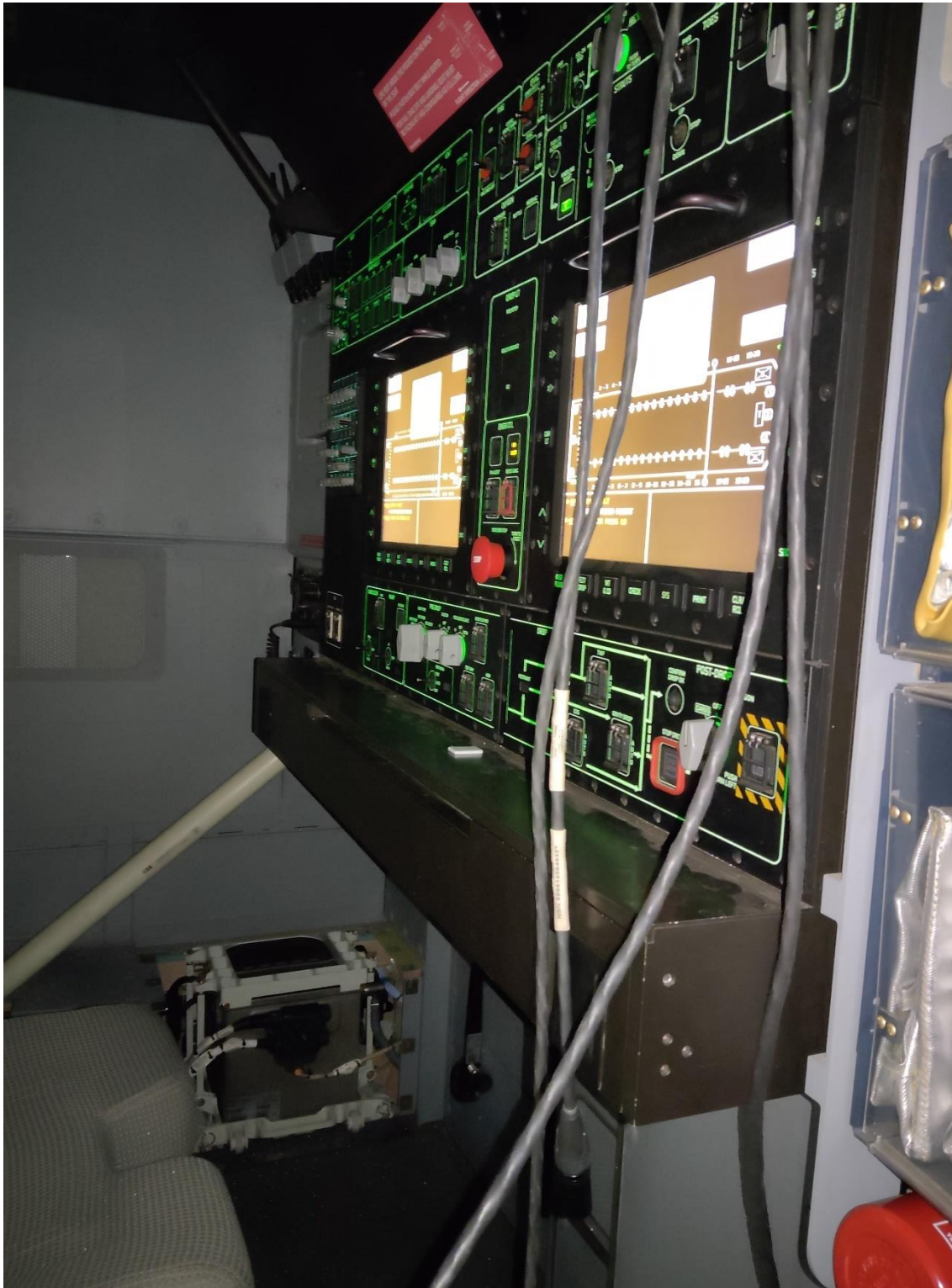
Fig. 50. Terminal de datos. Es el dispositivo electrónico que permite la comunicación efectiva entre el personal de la cabina de vuelo y los encargados de la cabina de carga. El "loadmaster" recibe los datos de los pilotos y del personal de vuelo, y éstos a su vez de todo lo referente a la carga y al proceso de carga de la aeronave. Fuente: Elaboración propia.
