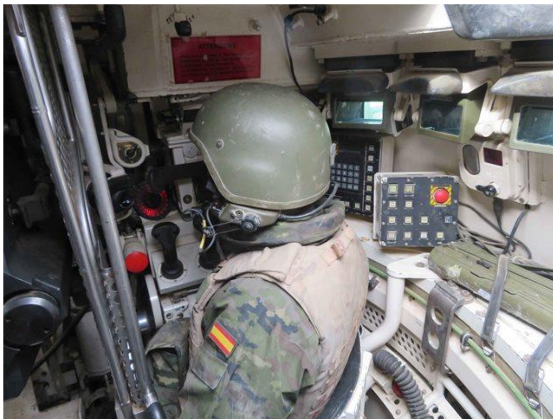
Fig. 72. Interior del vehículo. El VRCC Centauro es la piedra angular de las unidades de Caballería de primera línea, mostrando su polivalencia por la que destaca de forma notable, tanto en campo abierto como terreno urbanizado. En la fotografía se muestra el interior de la torre de dicho vehículo, concretamente el puesto del tirador, desde donde se realizan todas las operaciones oportunas que intervienen en el proceso de disparo. Fuente: Defensa.com
