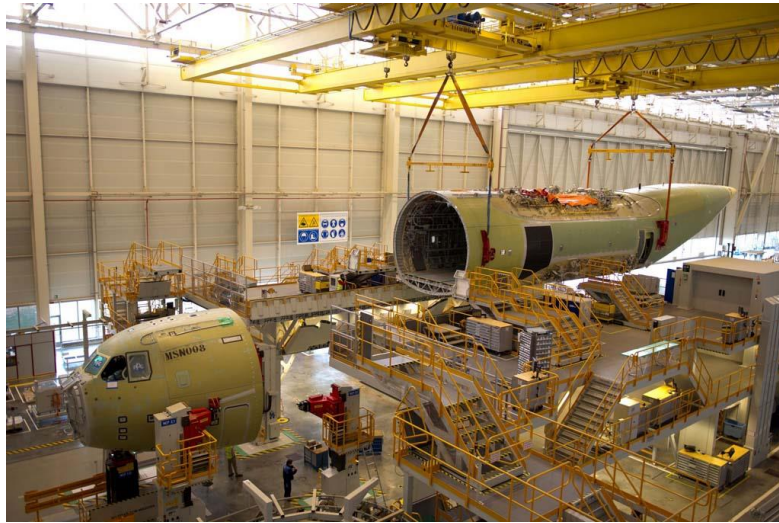
Fig. 10. El Airbus A400M se ensambla íntegramente en Sevilla. Fuente: Flynews.
