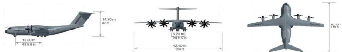
Fig. 8. Airbus A400M. Dimensiones. Fuente: Airbus Aerospace & Defense Europe.
