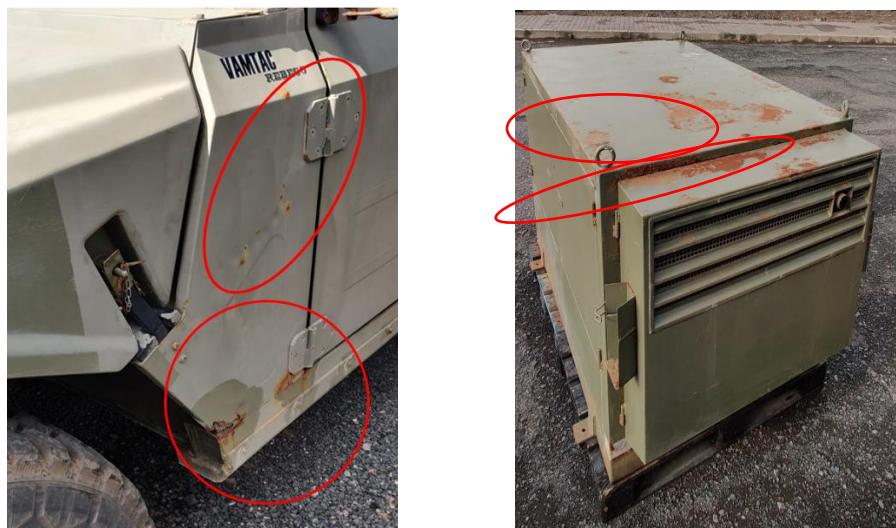
Figura 16. Vista lateral de un VAMTAC y grupo electrógeno con marcas de oxidación (elaboración propia)
