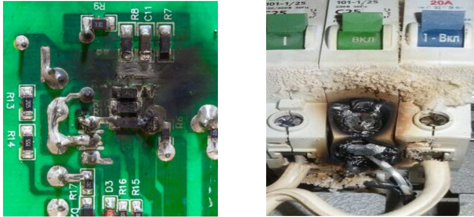
Figura 13. A la izquierda un circuito quemado; a la derecha un ICP quemado. Fuente: es.123rf.com
