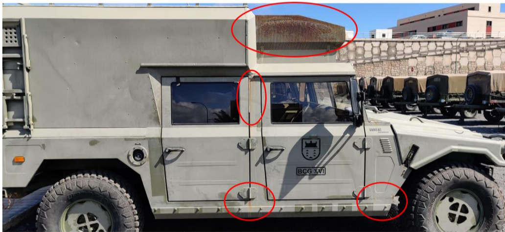
Figura 15. Vista lateral VAMTAC con marcas de oxidación (elaboración propia)
