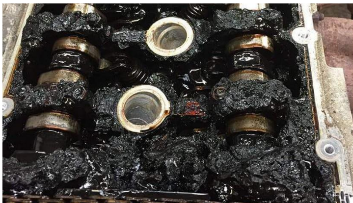
Figura 12. Vista desde el cárter de un motor sin cambio de aceite. Fuente: actualidadmotor.com
