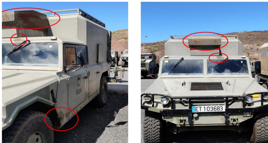
Figura 14. Vista frontal VAMTAC con marcas de oxidación (elaboración propia)
