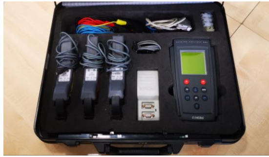
Figura 9. Analizador de redes portátil AR5.
