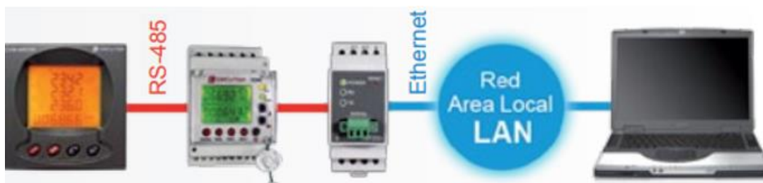
Figura 17. Funcionamiento general del analizador de redes [8].
