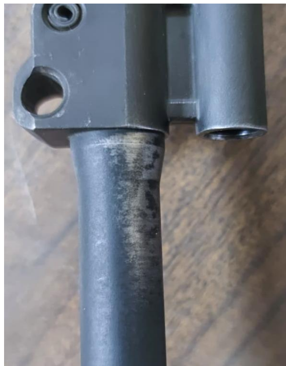
Ilustración 13. Fusil con pérdida de pavonado. Elaboración propia.
