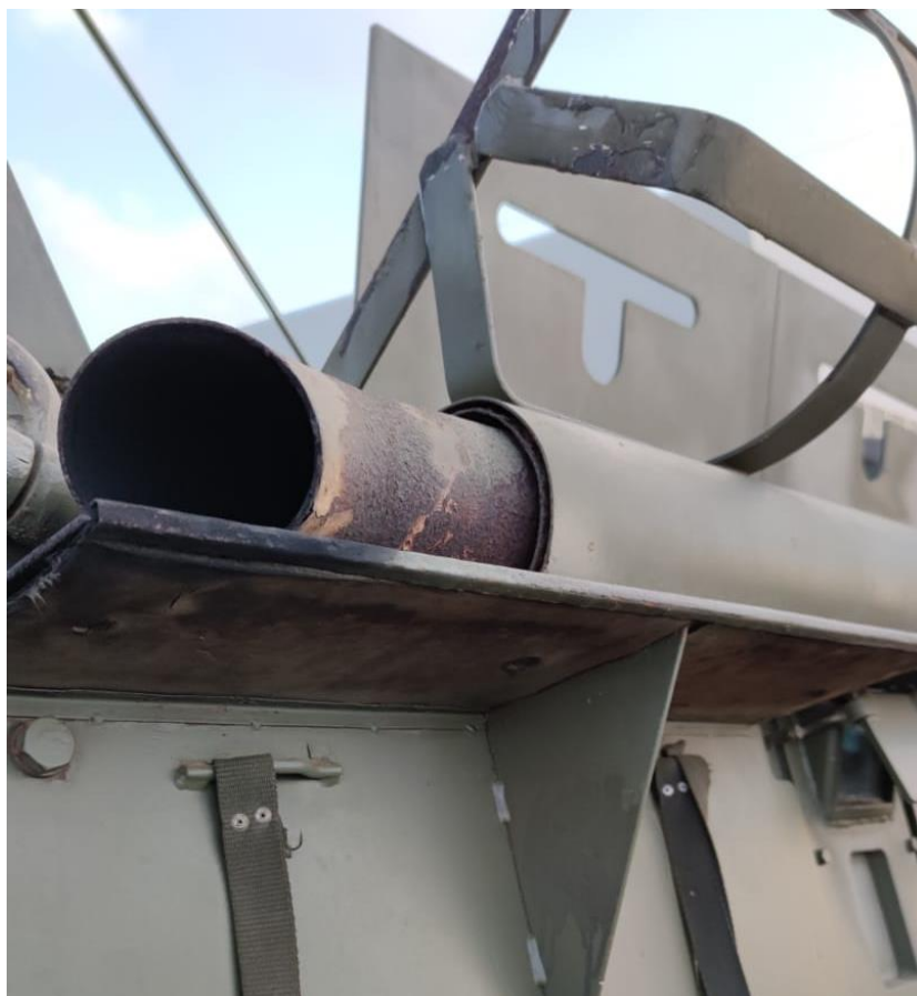
Ilustración 16. Óxido en escape de gases. Elaboración propia
