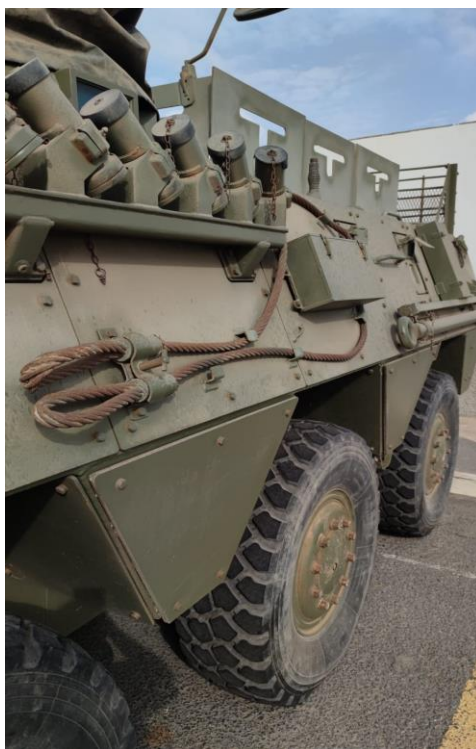
Ilustración 9. Óxido en eslingas de BMR. Elaboración propia
