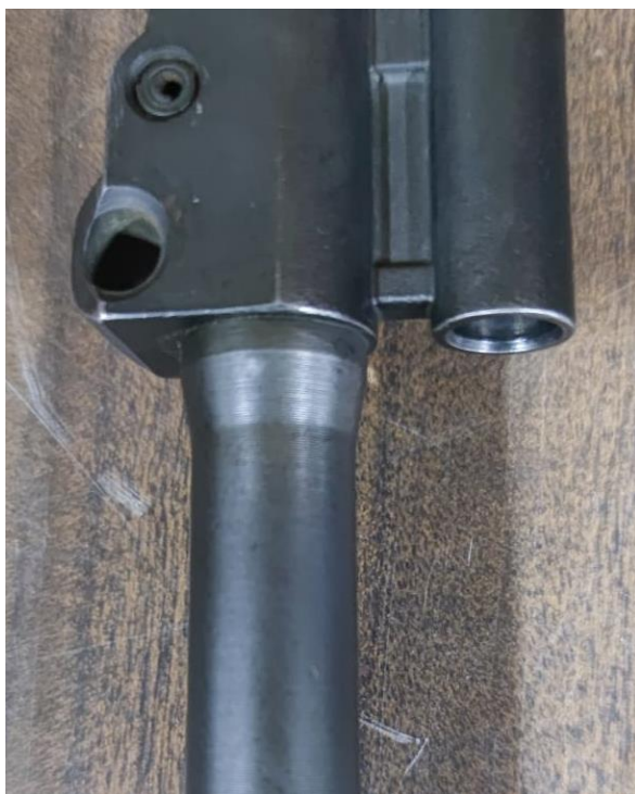
Ilustración 14. Fusil totalmente pavonado. Elaboración propia
