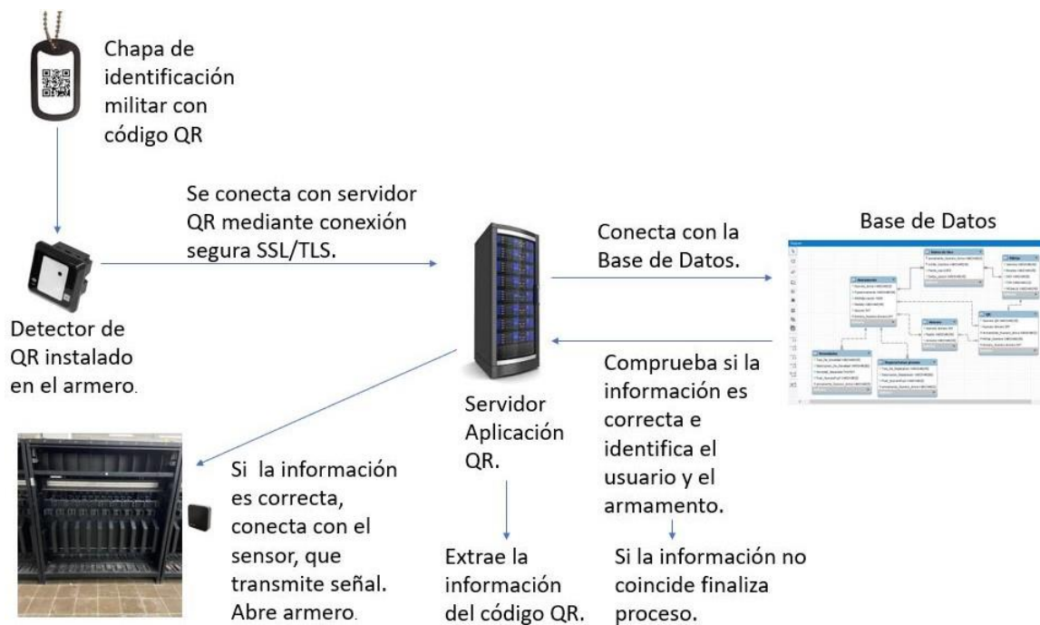
Figura 18 Esquema de funcionamiento método de códigos QR. Elaboración propia.
