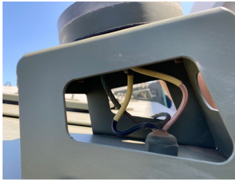
Ilustración 724. Base de antena con GPS y cable que conecta con la PR4G
