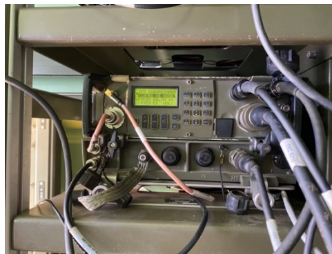
Ilustración 6 23 . Instalación vehicular de la PR4G con el BMS-Lince
