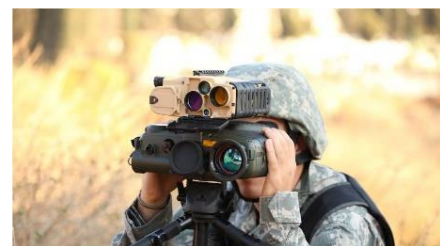
Ilustración 6 Fotografía en la que se muestra el uso conjunto del telemetro Rattler GX junto a la cámara térmica Coral CR-P. Fuente: página web fabricante Elbit System.
