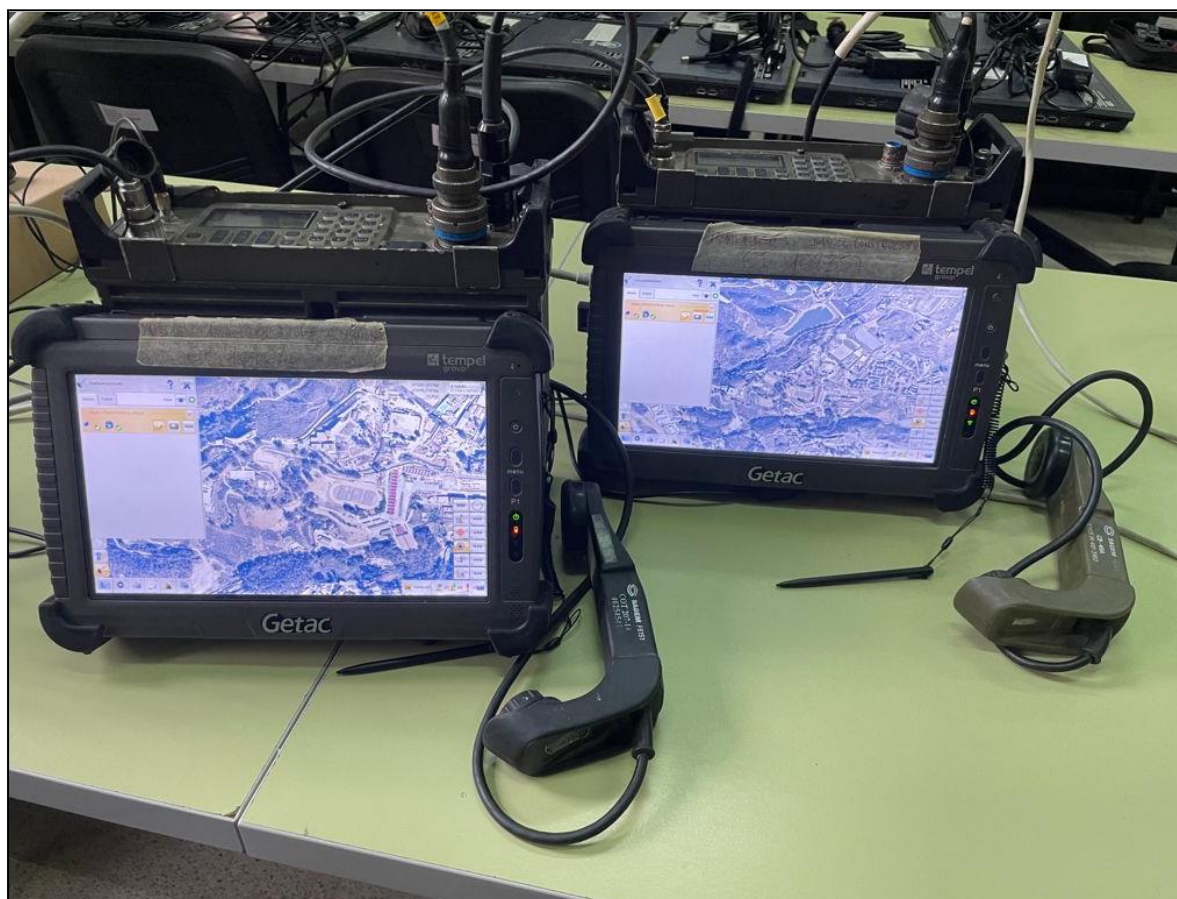
Ilustración 3: Montaje completo de dos nodos BMS. Elaboración propia.
