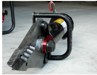
Ilustración 37. Pinzas hidráulicas de rescate. Doble efecto. Fuente: https://www.wikiwand.com/es/Herramientas_hidr%C3%A1ulicas_de_rescate
