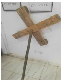
Ilustración 31. Cargas confeccionadas en cruz con madera. Apertura de butrón. Fuente: Sargento Ramírez. Fotografía realizada por el autor.
