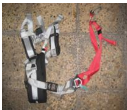
Ilustración 64. Arnés para descenso al alcantarillado. Fuente: U.E.S.
