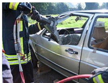
Ilustración 36. Pinzas hidráulicas de rescate. Efecto empuje. Fuente: https://www.wikiwand.com/es/Herramientas_hidr%C3%A1ulicas_de_rescate
