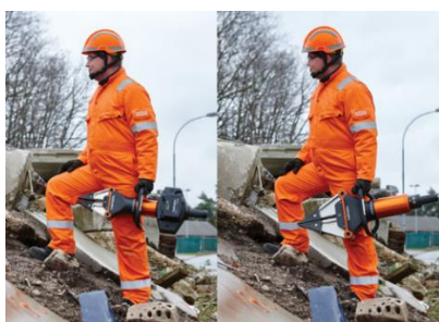
Ilustración 34. Pinzas hidráulicas de rescate. Fuente: https://elbomberonumero13.files.wordpress.com/2015/12/herramientas-eh-4.png
