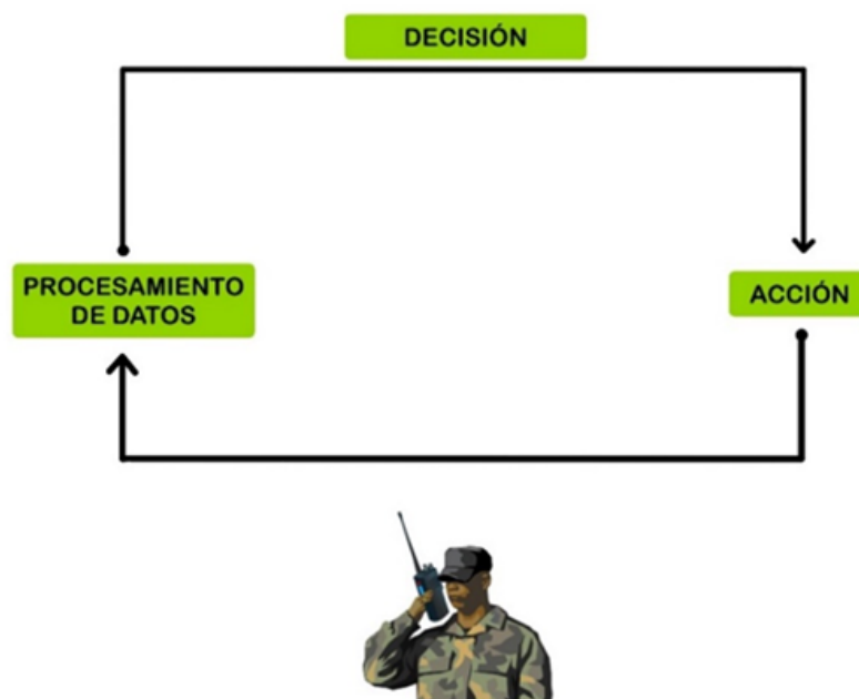
Ilustración 7. Esquema del modo plenamente autónomo (Human Out The Loop). Fuente: elaboración propia.
