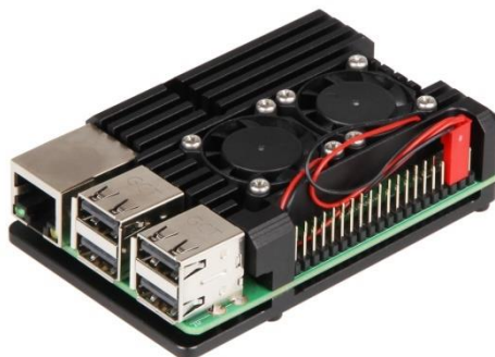
Figura 16: Carcasa protectora Joy-It junto con la Raspberry Pi 3 Model B+. Fuente: ( JOY-IT, 2021 ).
