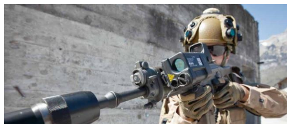
Figura 8: Sensores y sistema láser del SDI Gladiator Fuente: RUAG Group (2021)
