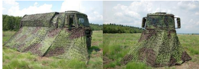
Figura 3. Camuflaje multiespectral combinado en un camión Tatra 810.[18]
