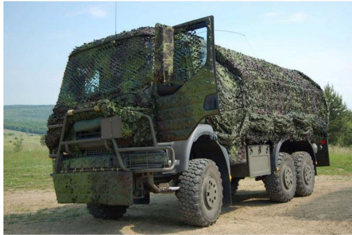
Figura 2. Camuflaje multiespectral móvil en un camión Tatra 810. [18]
