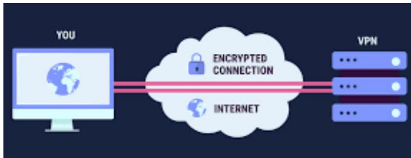
Figura 6: Estructura VPN (Fuente: (Dataustral, 2021) )
