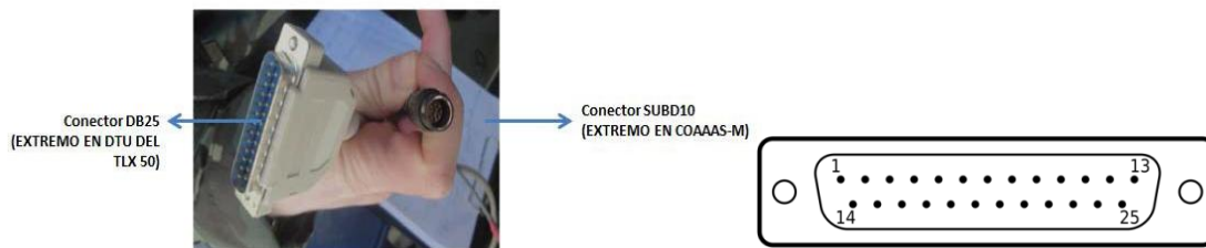
Figura 19. Izquierda: Conectores del cable DB25/SUBD10. Derecha: Pineado de un conector DB25. Fuente: Elaboración propia.
