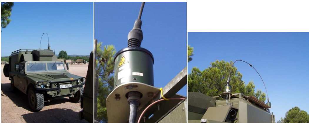
Figura 10. Izquierda: Vehículo VAMTAC con antena Chelton. Centro y derecha: Detalle de la toma de antena Chelton. Fuente: Elaboración propia.
