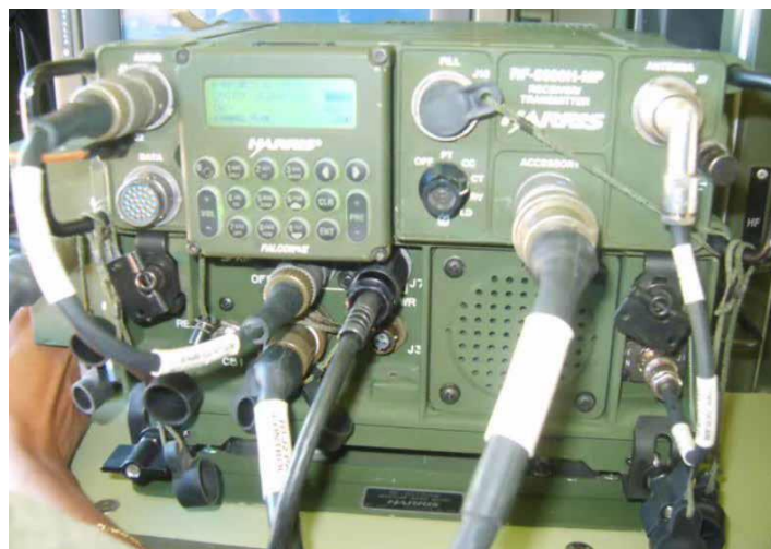
Figura 39. Foto de radio RF-5800H conectada a amplificador vehicular RF-5833H. Fuente: [7].
