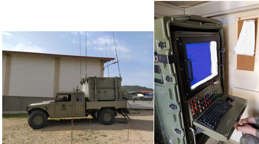
Figura 4. Izquierda: Cabina del COAAAS-L sobre vehículo VAMTAC. Derecha: Fotografía de la UCE, ubicada en el interior de la cabina del COAAAS-L. Fuente: Elaboración propia.
