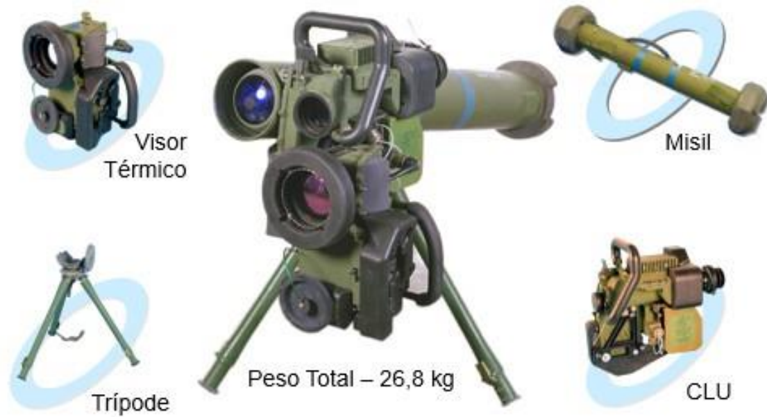
Figura 8. Elementos del sistema DCC Spike LR Dual. Fuente:[15].
