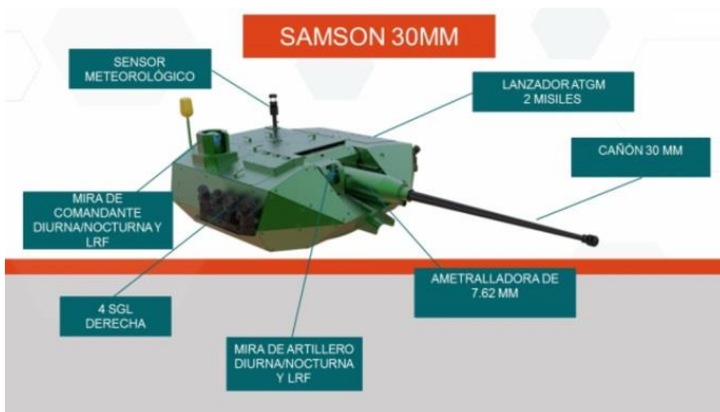
Figura 18. Partes de la torre Samson 30 mm MKII. Fuente: [24]
