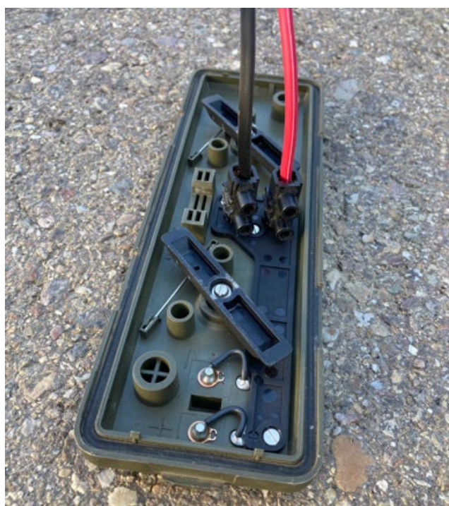
Figura 9 Conexión de cables
