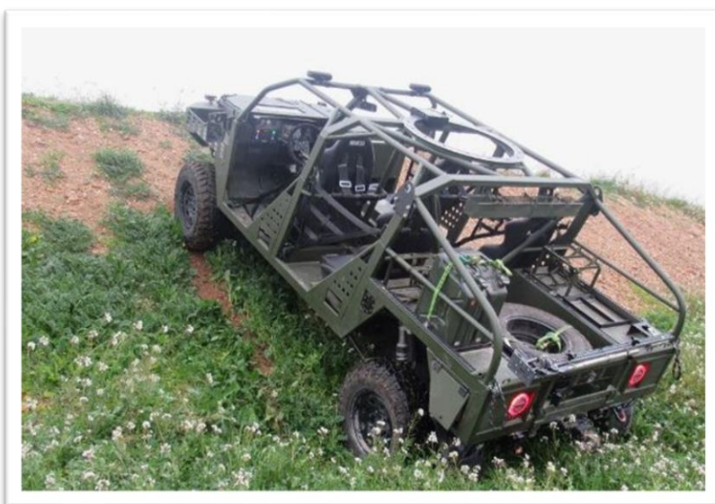
Figura 13: Netón Mk2. Se observa la zona de carga en la parte trasera donde iría el dron cautivo. Fuente: defensa.com
