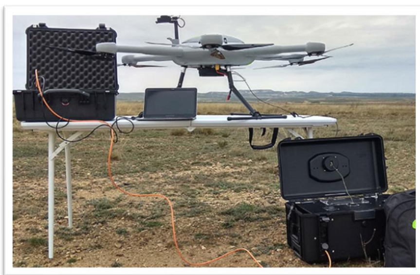
Figura 19: Dron cautivo ASTER-T. Fuente: scrdrones.com
