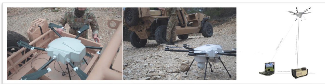
Figura 20: ORION 2. Se aprecia en la imagen su tamaño reducido y la estación Light T (así como el ordenador de control desde el que lo maneja el usuario). Fuente: elistair.com.
