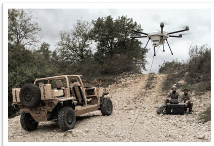
Figura 9: Equipo con dron cautivo montado en quad. Fuente: ELISTAIR. The tethered drone company (elistair.com) .
