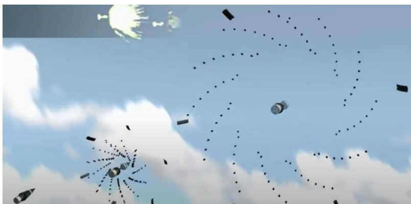
Figura 20. Momento de la liberación de los subelementos de la munición AHEAD [32]
