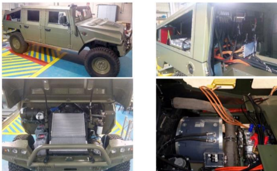
Figura 5.10: Instalación de los sistemas necesarios para la propulsión híbrida (Díez Cámara, 2021).
