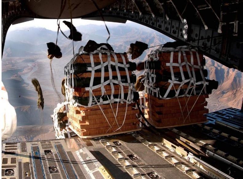
Ilustración 5. Lanzamiento de plataformas. Carga confeccionada sobre planchas de honeycomb siendo lanzada por extracción. Fuente: (Wikiwand, s.f.)
