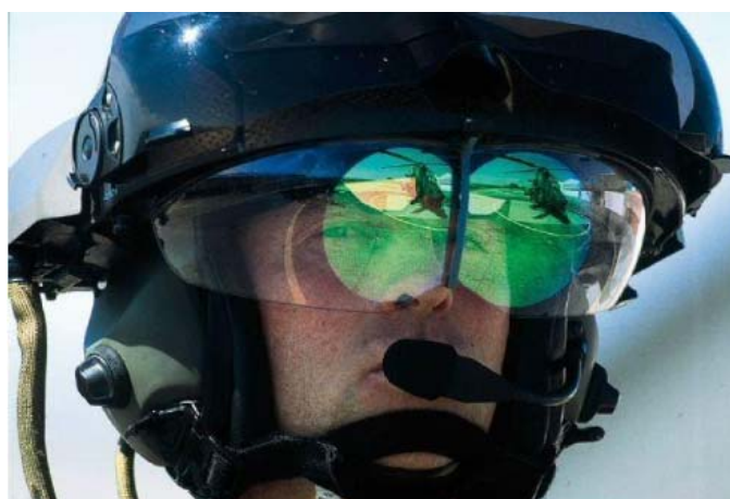
Figura 14. Casco TopOwl con sistema GVN Thales instalado. Fuente: Diapositivas de instrucción, BHELA I.
