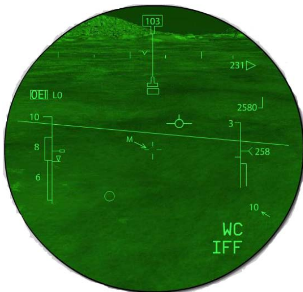
Figura 13. Visión nocturna incorporada al casco HMSD durante vuelo en simulador de NH-90. Fuente: Diapositivas de instrucción, BHELMA III.
