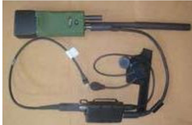
Figura 5: Radioteléfono SPEARNET. Fuente: Ministerio de Defensa & Departamento de Comunicación del Ejército de Tierra (s.f.)
