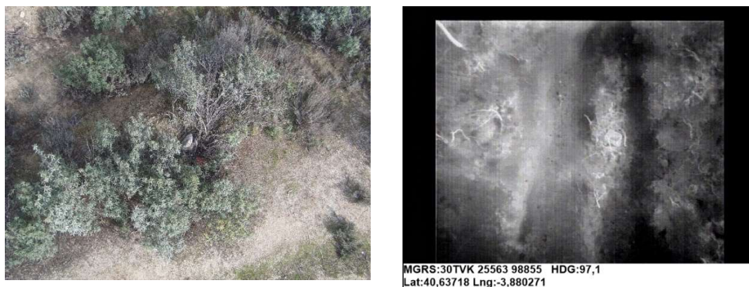
Figura 2: Comparativa de cámara HD con sensor multiespectral para localizar una caja de munición oculta bajo la vegetación (Fuente: Archivo Cor Jiménez)
