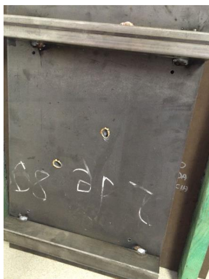
Figura 16. Testeo del acero dulce con proyectiles de arma larga (Elaboración propia)
