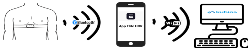
Figura 6 - Esquema de interconexión del software y material empleado. Elaboración propia
