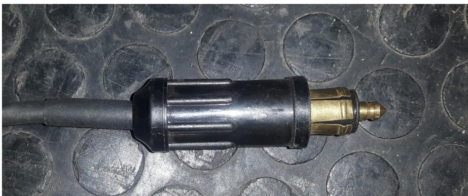
Figura 21. Conexión eléctrica tipo toma de mechero. Fuente: Instalación del Programa Integral de refrigeración
