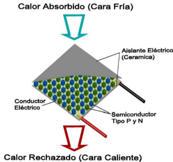
Figura 17. Partes de la Célula Peltier. Fuente: Efecto Peltier y desarrollo de posibles aplicaciones.
