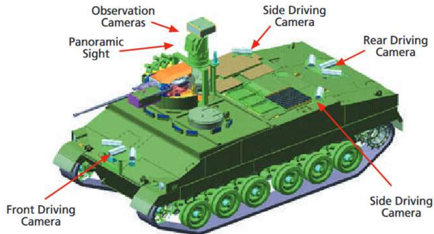
Ilustración 28 Disposición de los sensores en el vehículo para su teleoperación. (DSTA, 2020)
