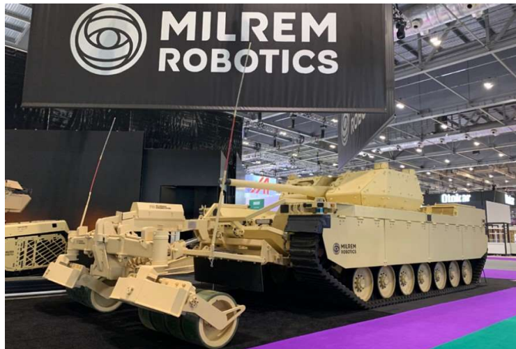
Ilustración 34 Type X con rodillos detonadores de minas. (MilitaryLeak, 2021)
