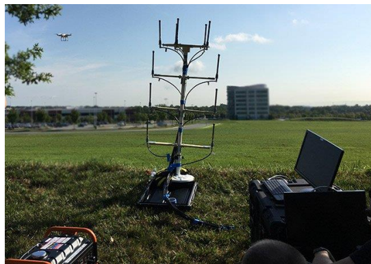
Figura 20. C-UAS MESMER configurado (Department 13, 2017).
