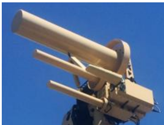
Figura 8. AUDES. Sistema de neutralización. Inhibidor (Gallego, 2020).
