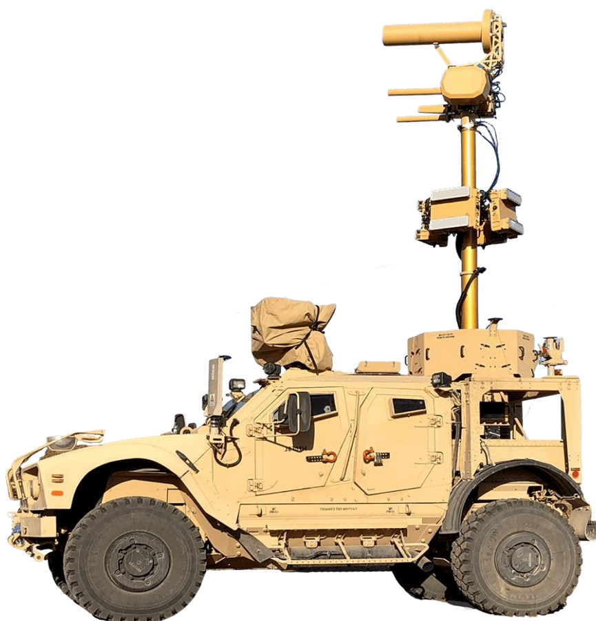
Figura 25. Anexo III. AUWS sobre vehículo [37].
