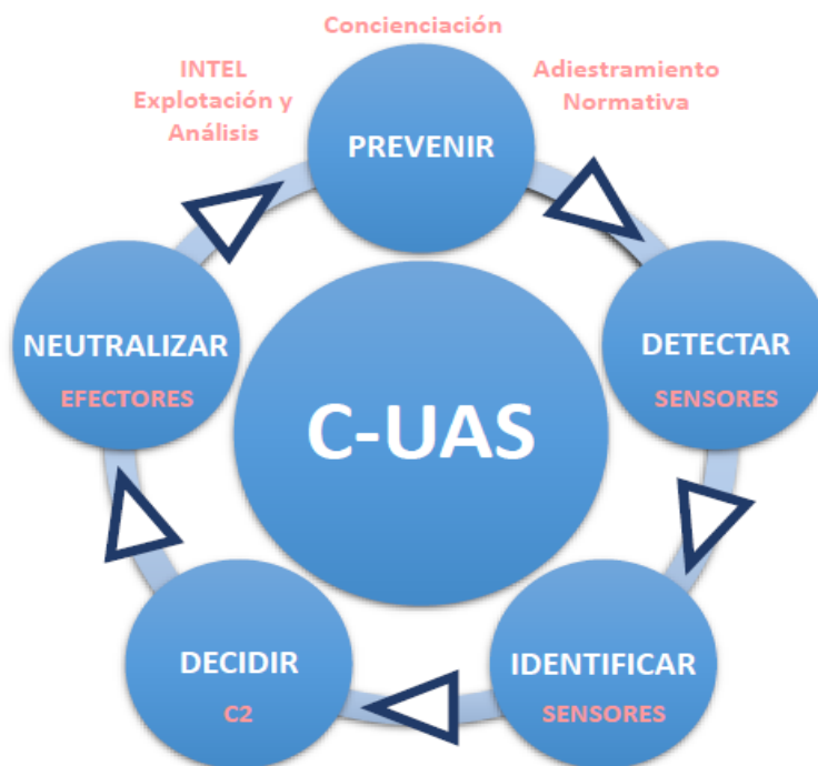
Figura 2. Ciclo de los sistemas C-UAS [1].
