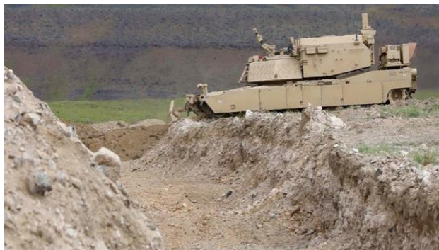
Figura 14. Abrams M1 no tripulado y equipado con pala empujadora abre brecha en un foso contra carro durante el ejercicio Joint Warfighting Assessment 19. Fuente: https://www.foxnews.com/tech/army-tests-robot-force-attack-on-enemy-tank-ditch-minefield .
