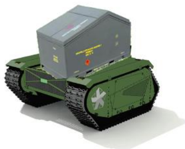
Figura 23. UGV THeMIS transportando la manguera explosiva Plofadder 160 AT MKII. Fuente: Elaboración propia
