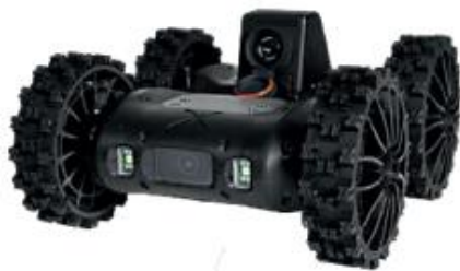
Figura 21. NervaLG equipado con cámara térmica. Fuente: Nexter Robótica.
