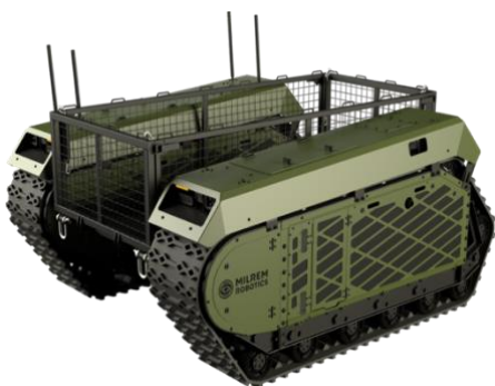
Figura 15. THeMIS de carga que podría transportar diferentes tipos de cargas de línea hasta el obstáculo. Fuente: https://milremrobotics.com/defence/
