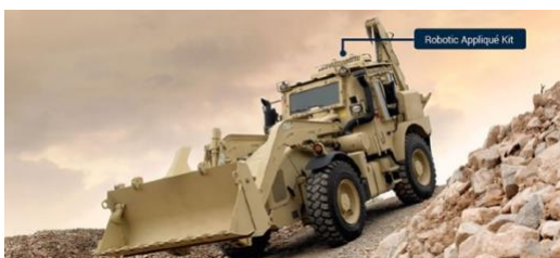
Figura 12. Excavadora de ingenieros de gran movilidad modificada con el RAK 3 para dotarla de semi-autonomía y capacidad de ser tele-operada. Fuente: https://www.qinetiq.com/en/what-we-do/services-and-products/rak-3-next-generation-interoperable-robotic-applique-
