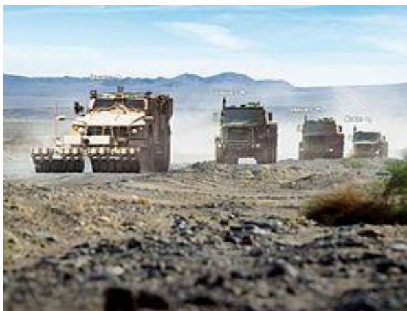
Figura 11. Convoy formado por 4 vehículos. Los tres primeros no tripulados y operados por TerraMax, el último está tripulado. El primer vehículo lleva un rodillo incorporado y está realizando una limpieza de ruta. Fuente: https://en.wikipedia.org/wiki/TerraMax .
