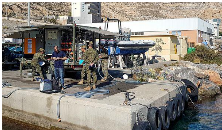
Figura 13. Ejemplo de planta potabilizadora SETA 3e 500. Fuente: Ejército de Tierra.
