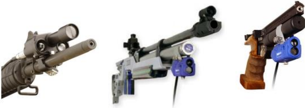
Ilustración 12: Acoplamiento de una unidad óptica a un rifle y pistola. Fuente: NOPTEL ST-2000. Manual de Usuario NOS 4.2.
