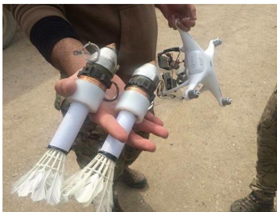
Ilustración 3. Dron DJI Phantom con granadas de 40mm modificadas para ser lanzadas desde el aire con precisión. [Fuente: Clipset.com]
