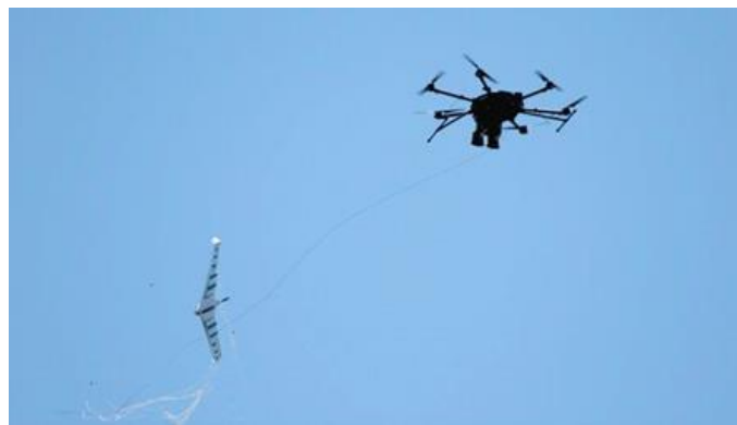
Ilustración 19. Dron de SkyDome System capturando con una red un dron intruso. [Fuente: janes.com]
