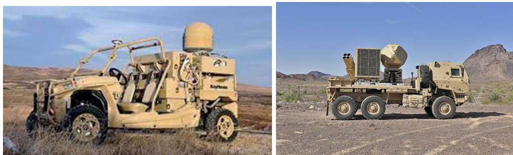
Ilustración 20. Arma láser de alta intensidad sobre vehículo ligero y estación de sensores sobre vehículo pesado [Fuente: raytheonmissilesanddefense.com]
