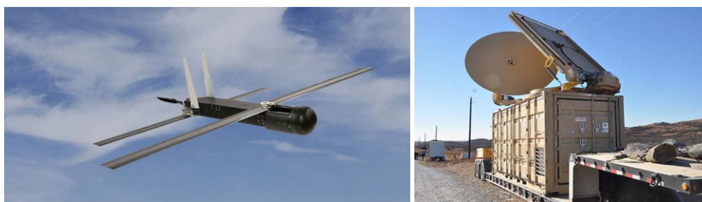
Ilustración 21. UAV Coyote y estación emisora de ondas electromagnéticas de alta potencia. [Fuente: raytheonintelligenceandspace.com]
