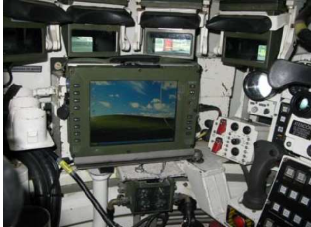
Figura 1: BMS-LINCE instalado sobre CC Leopard 2E. Fuente: "Sistemas de Mando y Control de Caballería" (AGM-TM-402)
