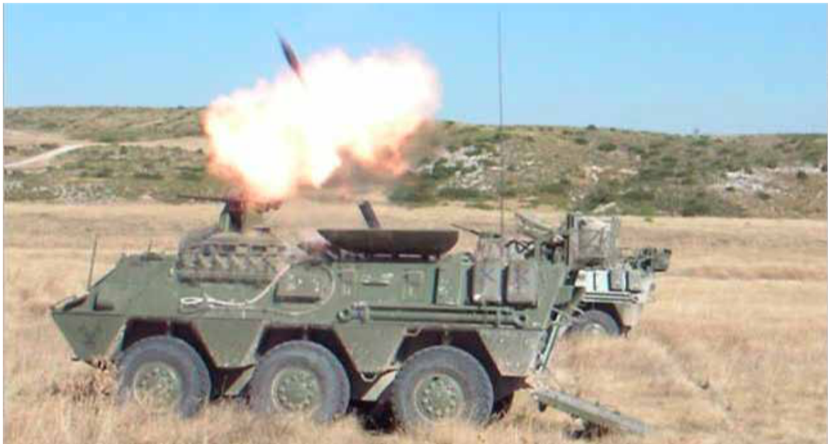
Figura 39:escuadra de morteros pesados una vez efectuado el fuego; destacando el peligro que supondría el estar de pie junto a la boca de fuego en el momento del disparo. Fuente: Manual MI4-206: “Escuadra/Pelotón de Morteros Pesados de Caballería”.
