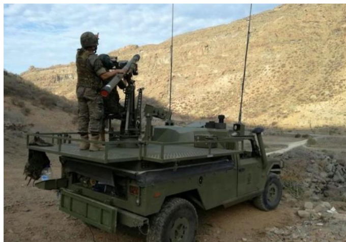
Ilustración 34: Sistema de Armas Mistral montado sobre vehículo VAMTAC. Fuente: archivos del RAAA71.
