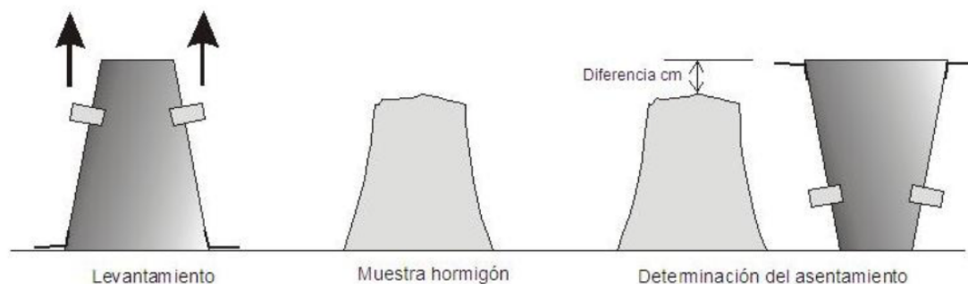
Ilustración 15: Método del Cono de Abrams Fuente: (Programa de Afiliados de la Construpedia, s.f.)
