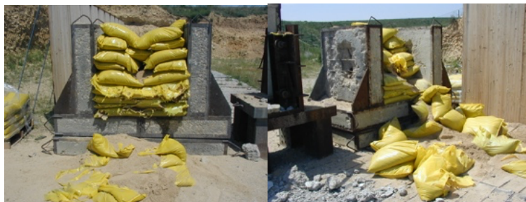
Ilustración 14: Efectos sobre sacos terreros Fuente: Instalaza
