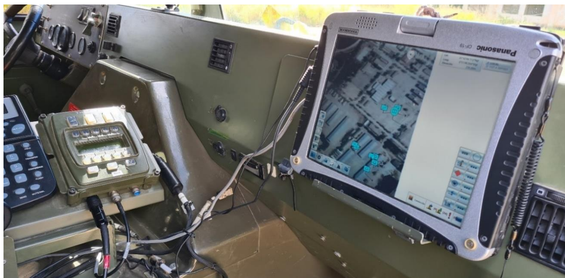
Figura 13. Terminal BMS instalado en la estación SORIA
